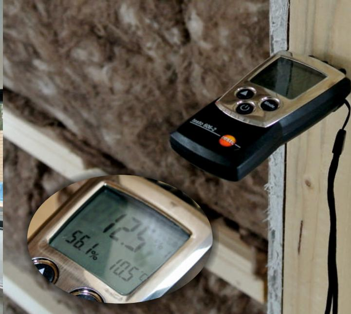
Nekompromisní kontrola stavby měřením vlhkosti v konstrukci a detekcí kouřem. Efektivní lokalizace nevhodně provedených konstrukční detailů i v členitých budovách.
