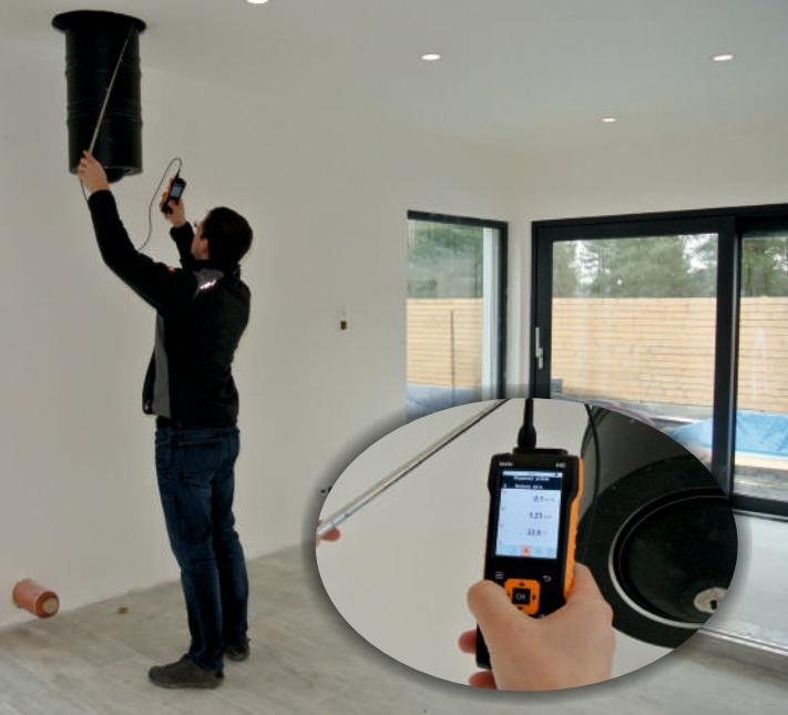
Anemometrem s teleskopickou sondou s dosahem měření až do výšky 3 m mnohostranně zkонтrolujeme obtížně přístupná místa v obálce budovy.
